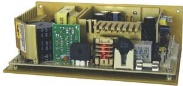
Рис. 1. АС/DC-, DC/DC-преобразователь серии LPQ110-В
