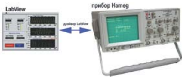
Рис. 3. Структура связи измерительного прибора с виртуальным прибором LabView
