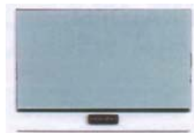
Рис. 3. ЖКИ, изготовленный по технологии COG
