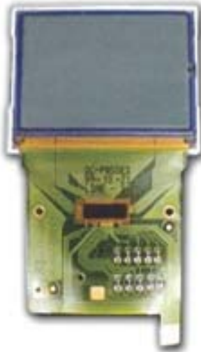
Рис. 4. ЖКИ, изготовленный по технологии COF
