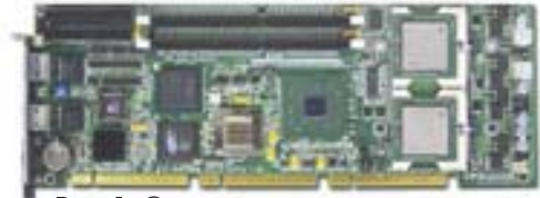
Рис. 1. Одноплатный промышленный компьютер ROBO-8820VG2
