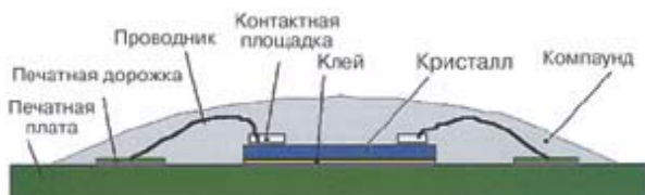
Рис. 2. Схематическое изображение конструкции ЖК-индикатора (технология COB)
